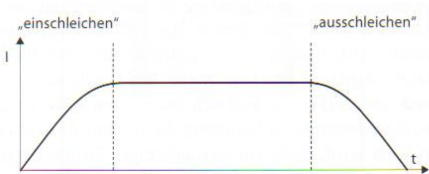
Abb. 2.34. Der zeitliche Verlauf von Gleichstrom. In der Anwendung wird zu Beginn die Stromstärke langsam hochgeregelt („einschleichen“) und am Ende langsam heruntergeregelt („ausschleichen“).
